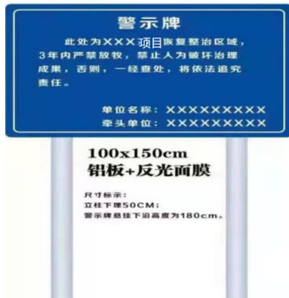
插图 5-2 警示牌结构设计示意图
